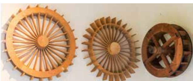
v.l.n.r.: Römisches Wasserrad mit geschlossenem Radkranz, Römisches Wasserrad mit offenem Radkranz, Mittelschlächtiges Rad
